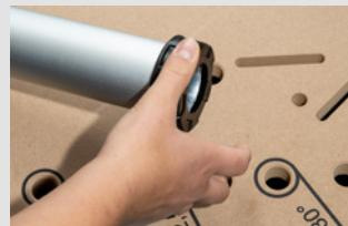
Führen Sie die Schlauchbeuteldüse durch den Sicherungsring. Setzen Sie anschließend die blaugelb Doppeldüse auf die Schlauchbeuteldüse und drehen Sie diese um ca. 90°, bis sie fest sitzt.
