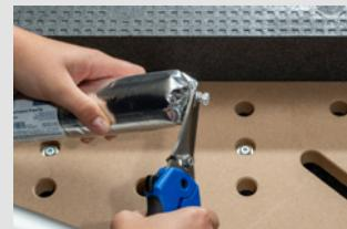
Schrauben Sie den Sicherungsring inkl. des Adapters und der Doppeldüse wieder auf die Pistole und richten Sie die Doppeldüse so aus, dass die Aussparungen nach oben zeigen.
