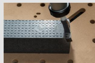
Führen Sie die Pistole gleichmäßig entlang des Profils, um einen kontinuierlichen Auftrag des Dichtstoffs zu gewährleisten.
