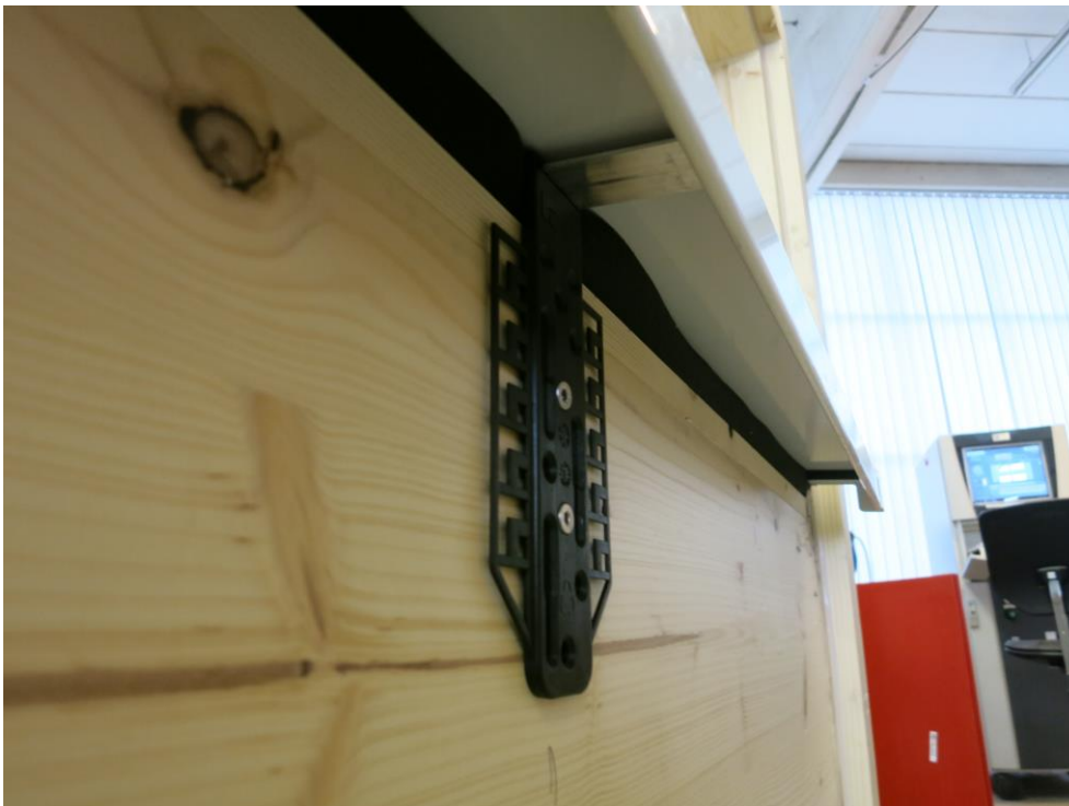
Bild 4 Prüfaufbau und Fensterbankeinbau mit Fensterbankhalter, Ansicht von außen, unten
