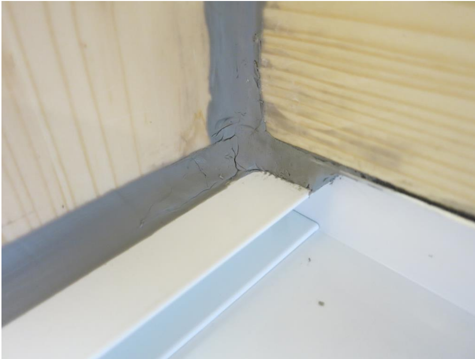
Bild 7 Ausbildung der Anschlussfugen zur Prüfvorrichtung
