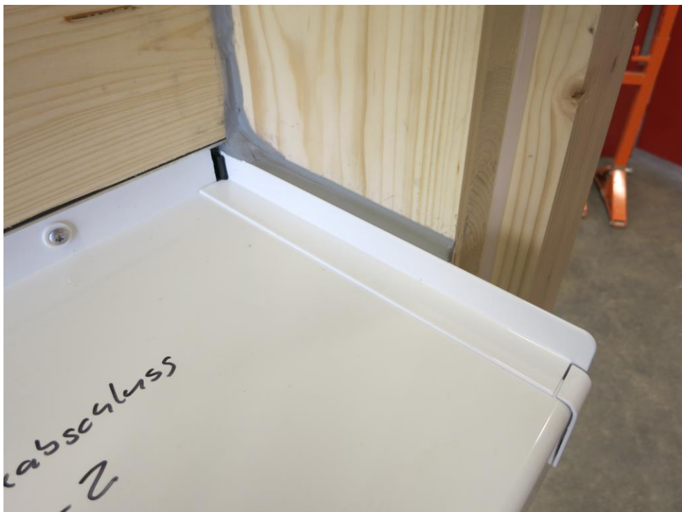
Bild 6 Prüfaufbau und Fensterbankeinbau BF 4004-Z, Ansicht von außen
