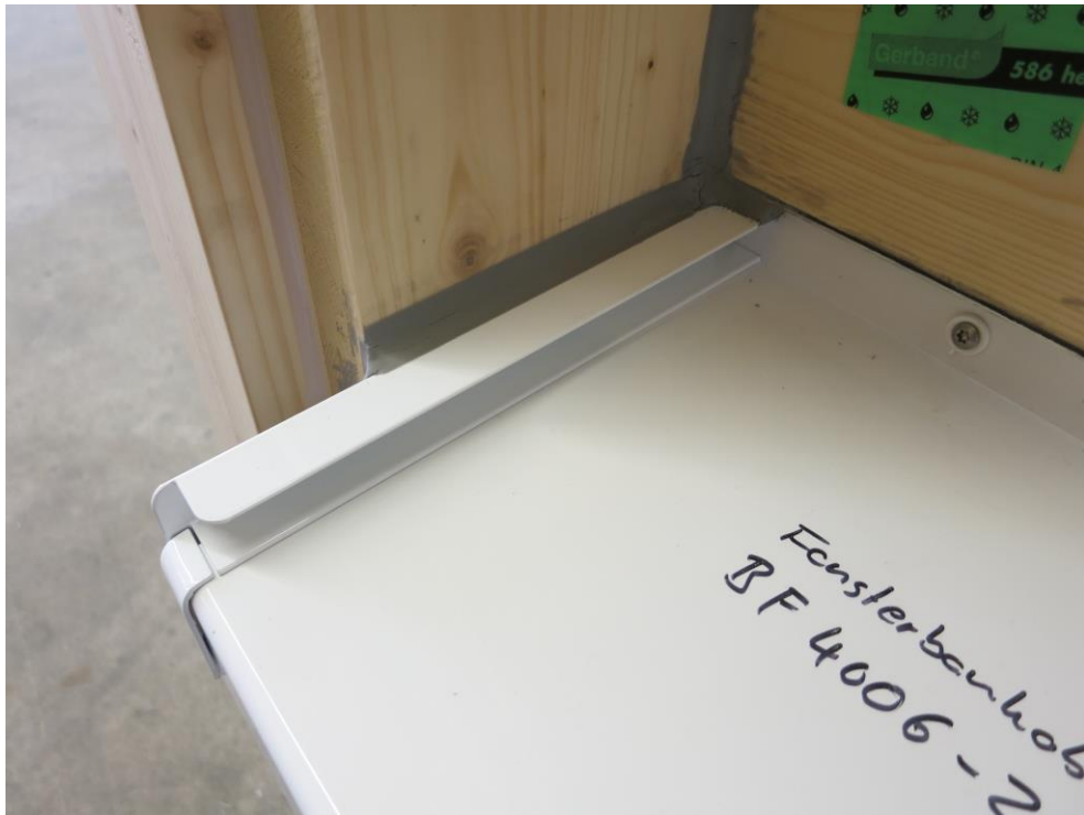
Bild 5 Prüfaufbau und Fensterbankeinbau BF 4006-Z, Ansicht von außen
